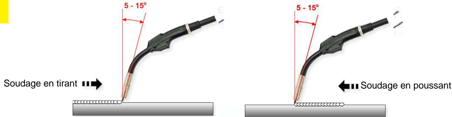
L'angle de la torche de soudage (sens longitudinal) dépend de la position de soudage.
